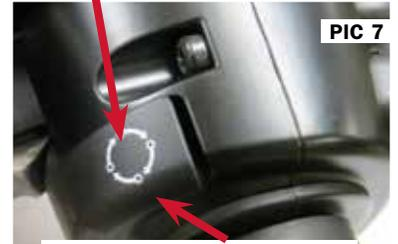
**TRIP ODOMETER RESET SWITCH ON TOURING MODELS**
