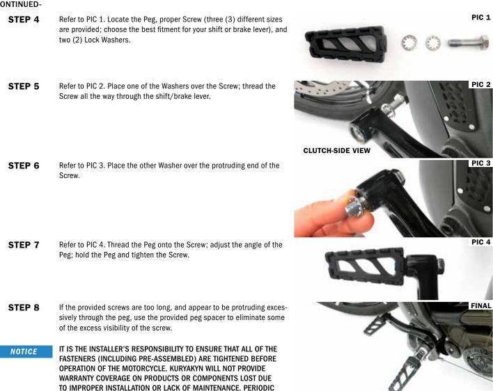
INSPECTION AND MAINTENANCE ARE REQUIRED ON ALL FASTENERS.
