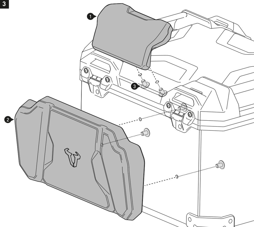
Montieren Sie die obere (1) und untere (2) Sozjus-Rückenlehne an das TRAX ADV Topcase, wie in der Zeichnung dargestellt.
