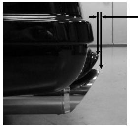
MUFFLER TIP MUST BE FLUSH OR EXTEND OUT NO MORE THAN A 1/4" PAST REAR VALENCE
